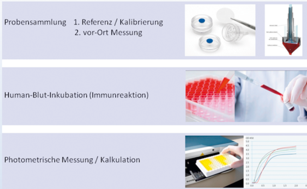
Abb. 2: Beispiel Luftmessung: Prozessablauf mit PyroDetect System. Eine mit Pyrogenen kontaminierte Probe (Filter) wird mit Humanblut in Kontakt gebracht und löst eine Immunreaktion aus, die mittels ELISA Verfahren nachgewiesen werden kann
